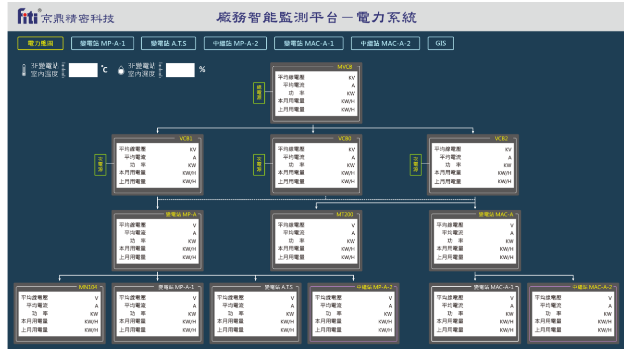
圖一 廠務智能監測平台-電力系統
